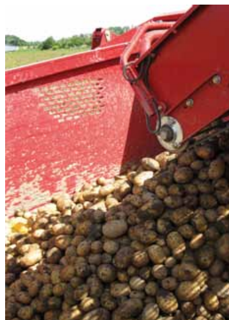
Fallstufen sollen soweit wie möglich vermieden werden
